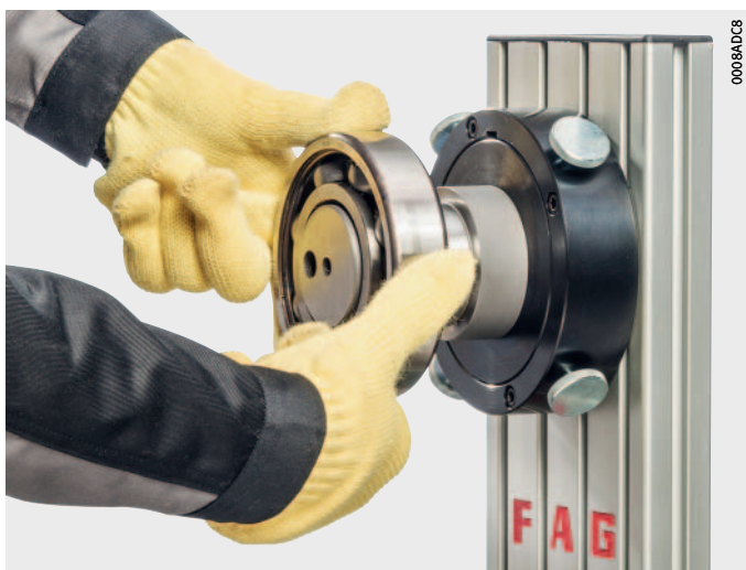
Bild 14 Montering av uppvärmda lagerdelar
