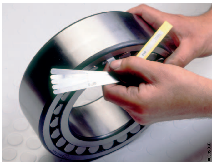
Bild 7 Mäta radialspelet med bladmätt
