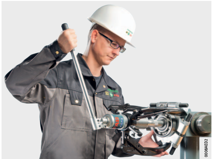
Bild 1 Demontering med avdragsanordning
