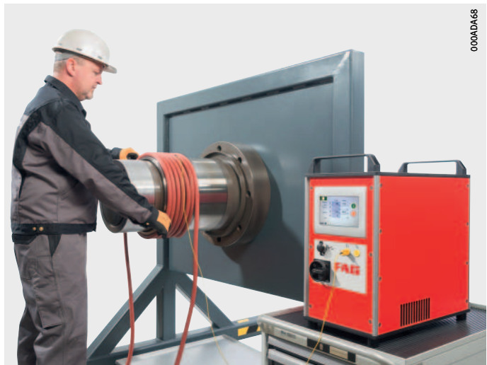
Bild 5 Demontering av innerlagringar med flexibel induktor
